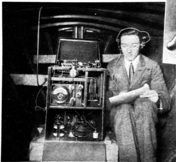
Funkanlage im Motorrettungsboot des Dampfers „Columbus“ mit dem Löschfunktende- und dem Hörempfangsgerät
